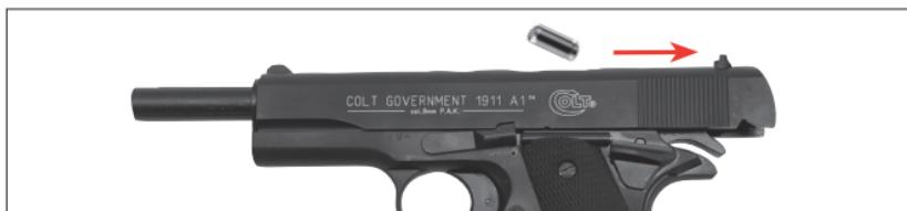
Извлечь магазин. Снять оружие с предохранителя. Удалить патрон из ствола, оттянув назад затвор.
