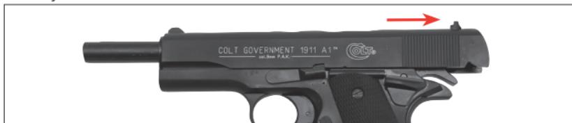
При оттягивании затвора назад и последующем его скольжении вперед патрон подается в ствол. Оружие теперь заряжено.
